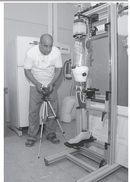
Von Ottobock gestiftetes Lasergerät, das zur Messung des Sitzes der Prothese erforderlich ist
